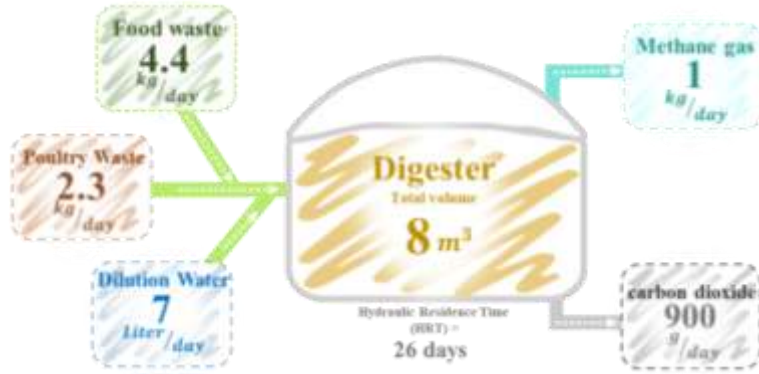
شكل 20: مخطط توضيحي لمداخلات ومخرجات المفاعل الحيوي
